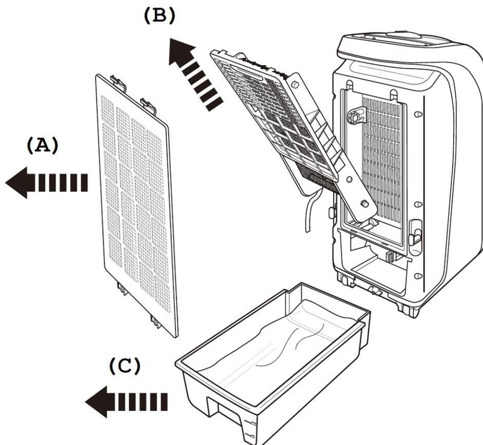
1. Enlever la grille contenant le filtre à air à l'arrière de l'appareil, utilisez les clips situés en haut. Utilisez un aspirateur pour l'entretien rapide. Passez le filtre à l'eau et faites bien sécher pour un entretien plus poussé. (A)
