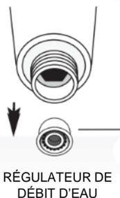
À l'aide d'une pointe de tournevis ou d'une pince à bec, retirez le régulateur de débit d'eau situé à l'intérieur du pommeau de douche.
